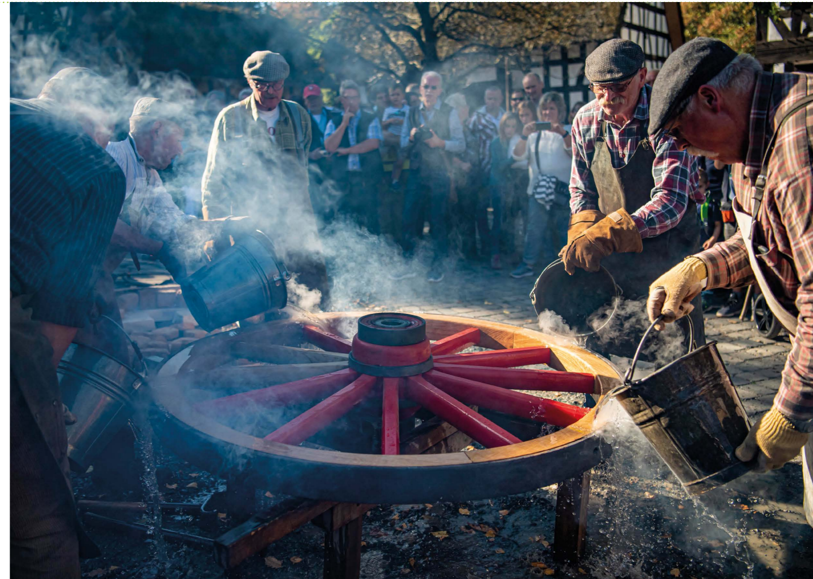
Bild 1 Schmied und Stellmacher ziehen einen eisernen Reifen auf ein hölzernes Wagenrad auf, 2018
