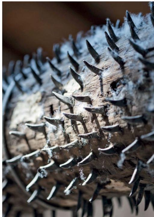
**Bild 3:** Diese hölzernen Walzen des Krepelwolves, die die Wolle auseinander reißen, mussten für den Vorführbetrieb erneuert werden, weil die Reißzähne in dem Holz keinen sicheren Stand mehr hatten. Diese Walze hängt über dem Wolf zur Ansicht und verdeutlicht den Austauschprozess für die Museumsgäste. (© LVR-Industriemuseum; Foto: Helmut Dahmen)
