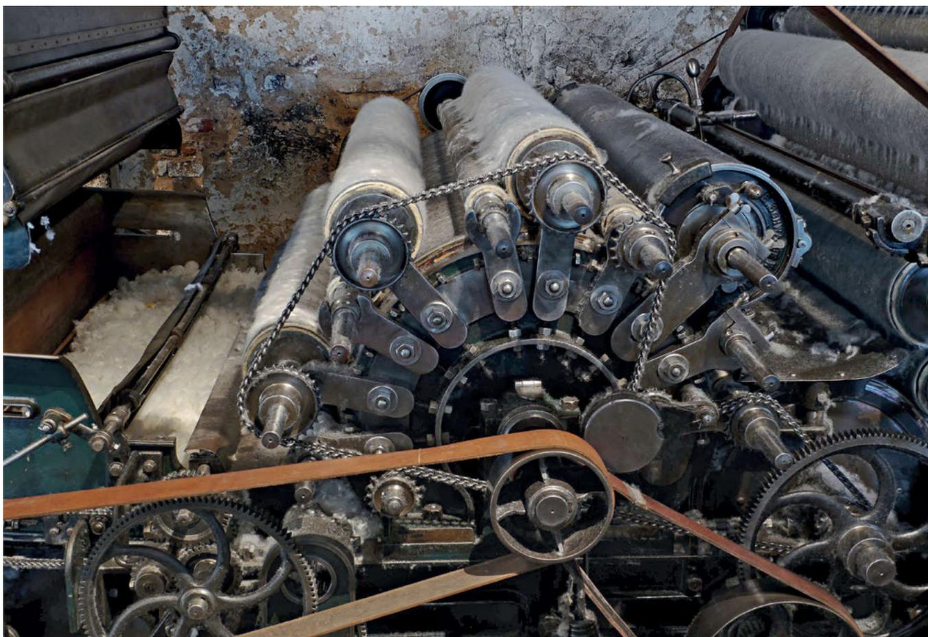
**Bild 2:** Auf dem Krempelsatz von 1913 wird wieder Wolle kardiert, um Vorgarn herzustellen. An dieser Maschine müssen immer mal wieder klassische Verschleißteile wie Antriebsriemen, Kratzenbelege und Nitschelhosen erneuert werden. Allerdings sind das Elemente, die auch schon im historischen Betrieb regelmäßig gewechselt wurden, wahrscheinlich sogar sehr viel häufiger als im reduzierten Museumsbetrieb.
