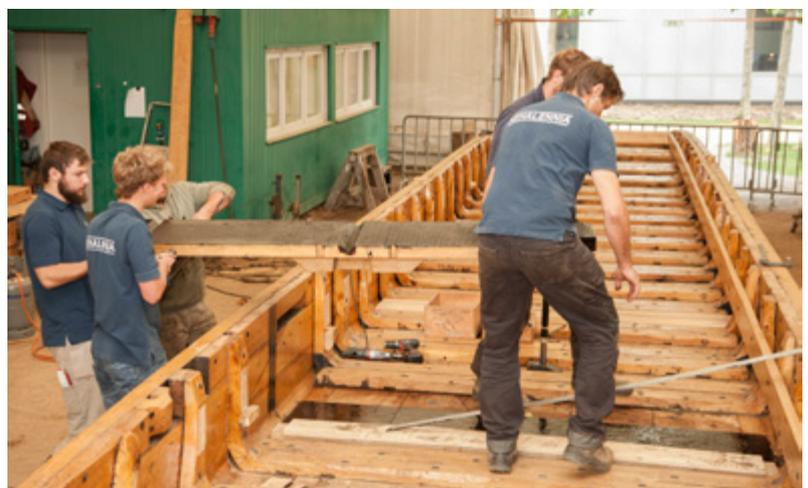
**Bild 3:** Abdichtung der Plankenfugen am Schiffsboden
