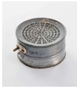
Bild 2 Nach dem Krieg war Improvisation gefragt: Ein kleiner Elektrokocher, gefertigt aus Gasmaskenteilen.
